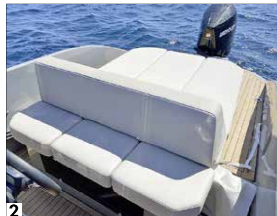
Le dossier du bain de soleil offre pas moins de quatre positions : façon leaning-post pour le pilote qui peut alors se tenir debout (1), avec un dossier droit pour piloter assis (2), avec un dossier pour une position de lecture (3) ou complètement à plat (4).
