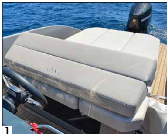
Le dossier du bain de soleil offre pas moins de quatre positions : façon leaning-post pour le pilote qui peut alors se tenir debout (1), avec un dossier droit pour piloter assis (2), avec un dossier pour une position de lecture (3) ou complètement à plat (4).
